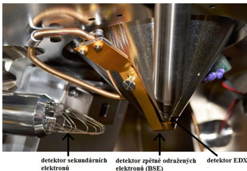
Obr. 10) Komora elektronového mikroskopu s popisem detektorů
