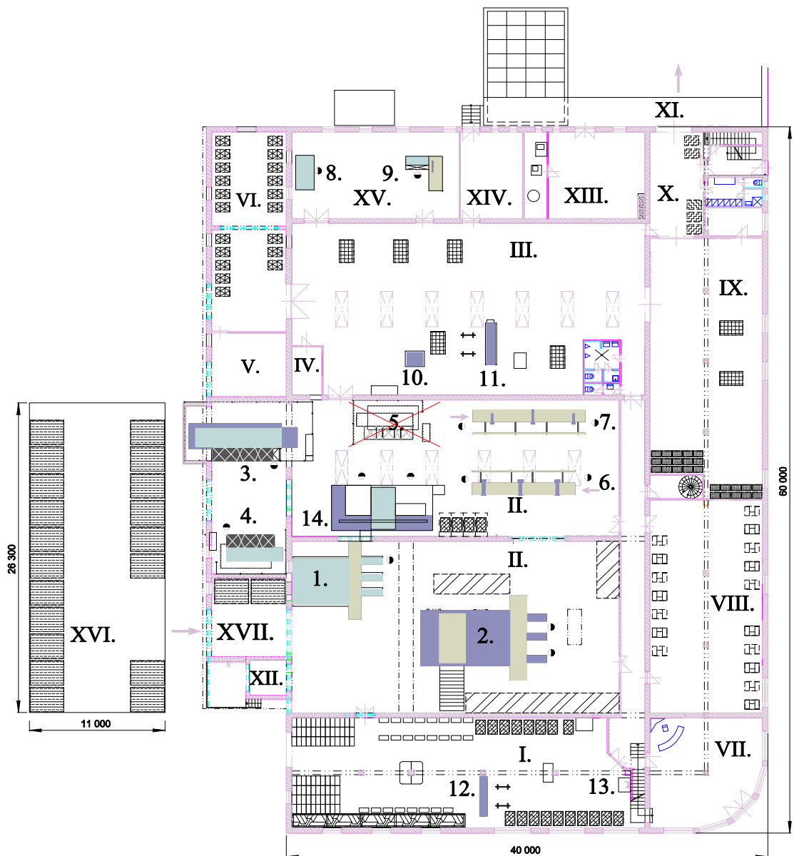
Obrázek 22: Situační zhodnocení náhrady nevyhovujícího CNC stroje WEEKE OPTIMAT Venture 3 strojem BHX 500_D
