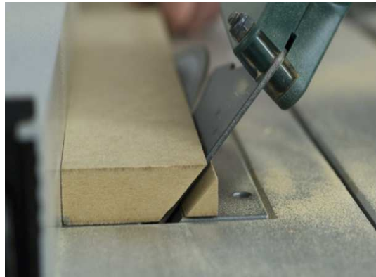
Obrázek 16: Řezání na formátovací pila Rojek PF 400 T pod úhlem 45°
