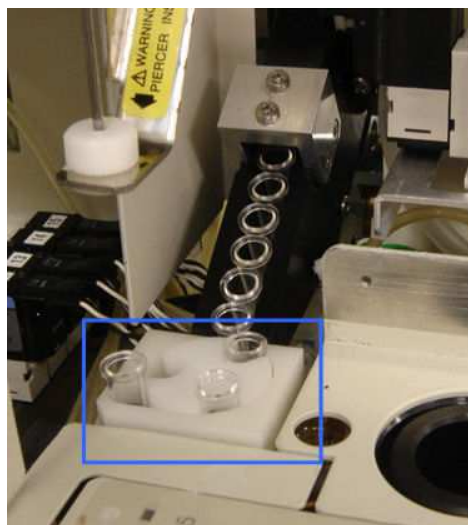
Obrázek 28: Systém podávání kyvet [26]
