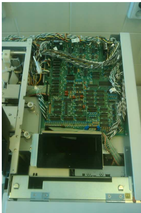
Obrázek 22: Řídící deska a zásobník kyvet
