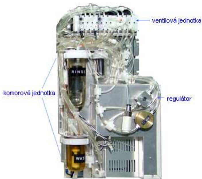
Obrázek 35: Hydraulická jednotka skřívající kompresor a objemové písky[26]
