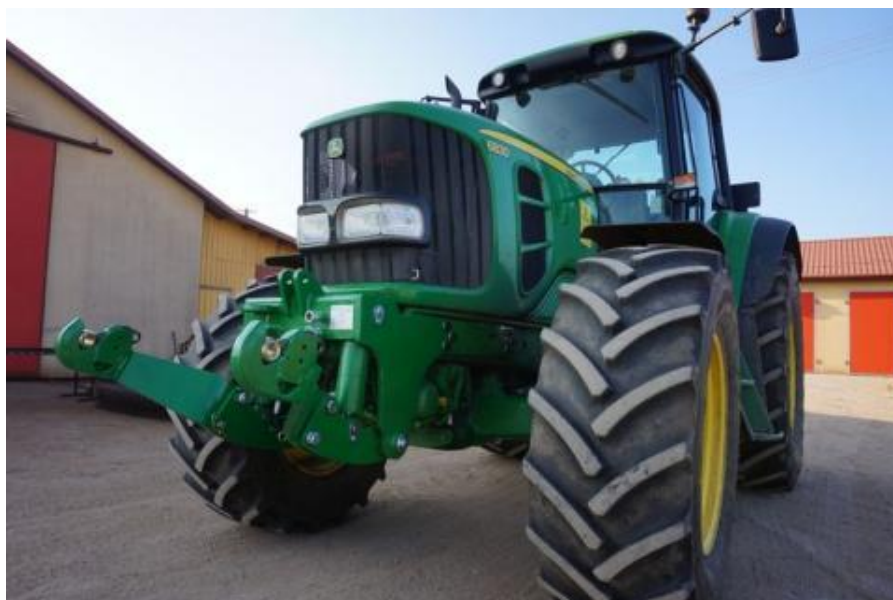
Obrázek 2 Přední třibodový závěs traktoru
