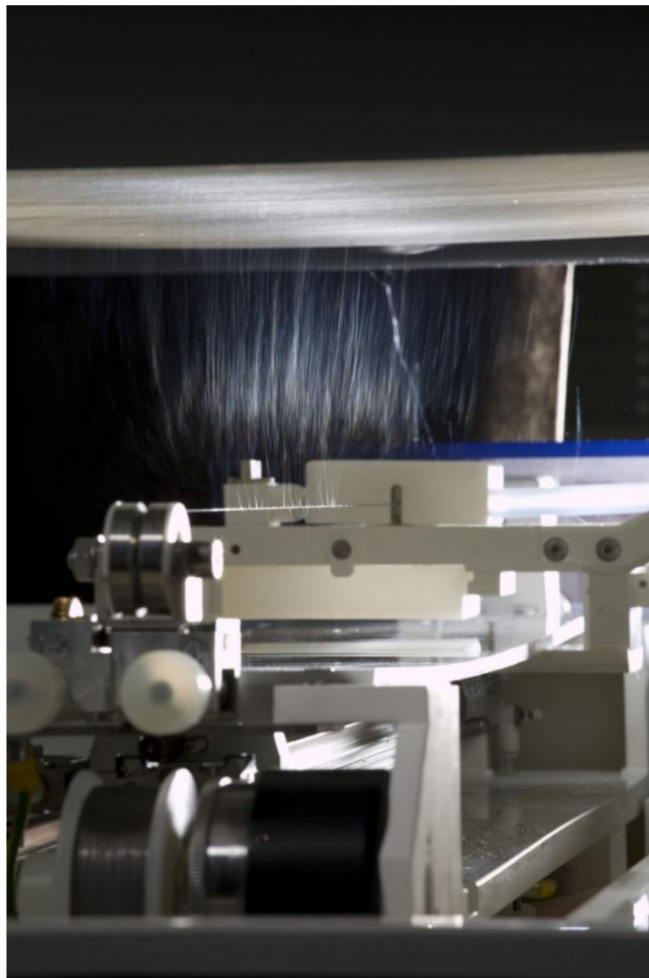
Obrázek 4: Zvlákňování technologií Nanospider [12]
