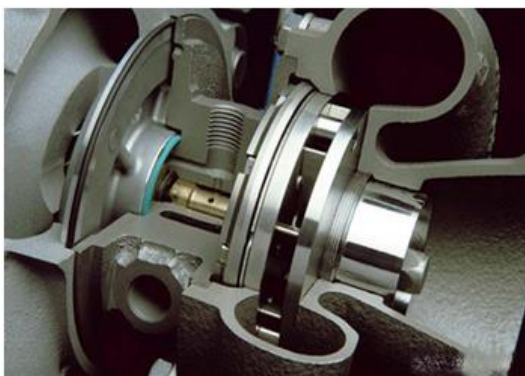
Obr. 15: Variabilní geometrie rozváděcích lopatek [28].
