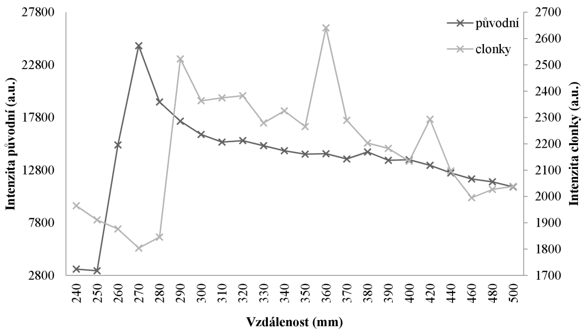
Obrázek 36: Závislost intenzity na vzdálenosti dusíkového dohasínání s přidavkem rtuti. Průtok aktivním výbojem 40% - 0,8 l/min, průtok titrační trubici 20% - 20 ml/min.
