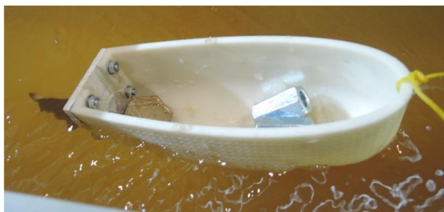
Obr. 3.18 – Lodička upravená pro zkoušku vlnového odporu
