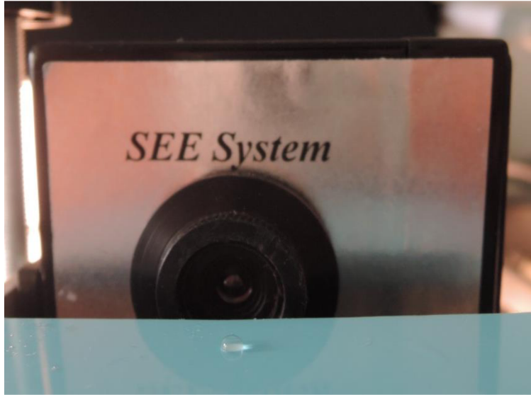
Obrázek 2.9 Snímaná kapka na testovaném vzorku
