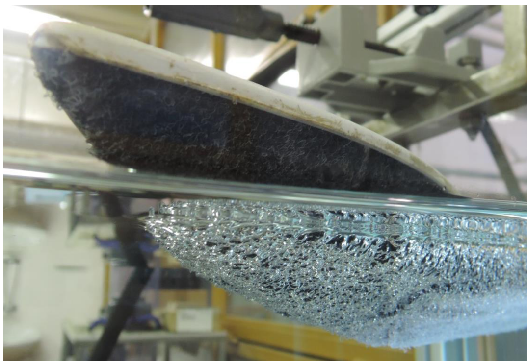
Obrázek 3.22 – Lodička se suchým zipem a nástřikem ultra ever dry
