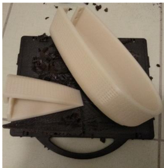
b) odstranění podpor
