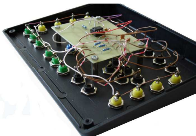
Obr. 8.7: Laboratorní přípravek – upevnění desky plošných spojů
