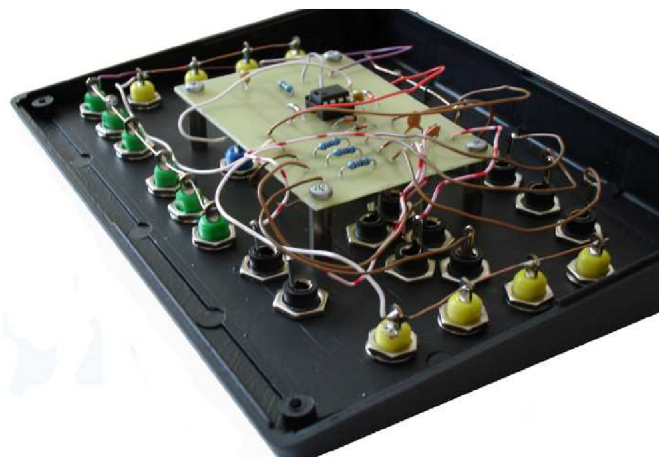
Obr. 8.7: Laboratorní přípravek – upevnění desky plošných spojů
