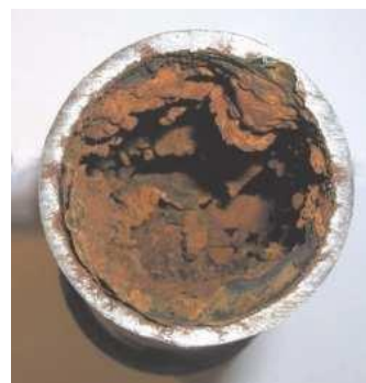
Obr. 4: Zanášení kovového potrubí [14]
