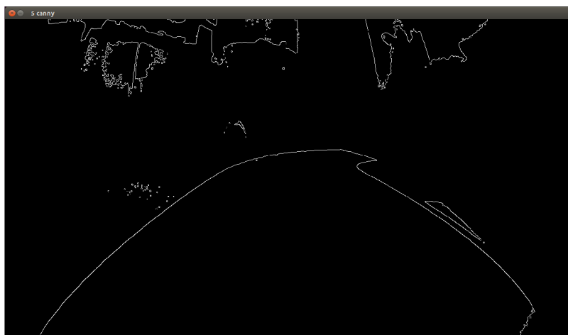
Obrázek 5.8: Výstup funkce canny zobrazující detekované hrany (galerie autora).
