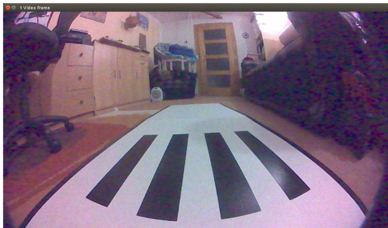
Obrázek 5.13: Vstupní snímek zachycující značku označující začátek úseku s omezenou rychlostí (galerie autora).
