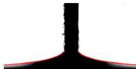
Obr. 24: Tvar kapaliny po vnoření příze [31]
