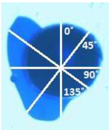
Obr. B. 3: Snímek po nanosení kapaliny na vzorek č. 2 se směry smáčení
