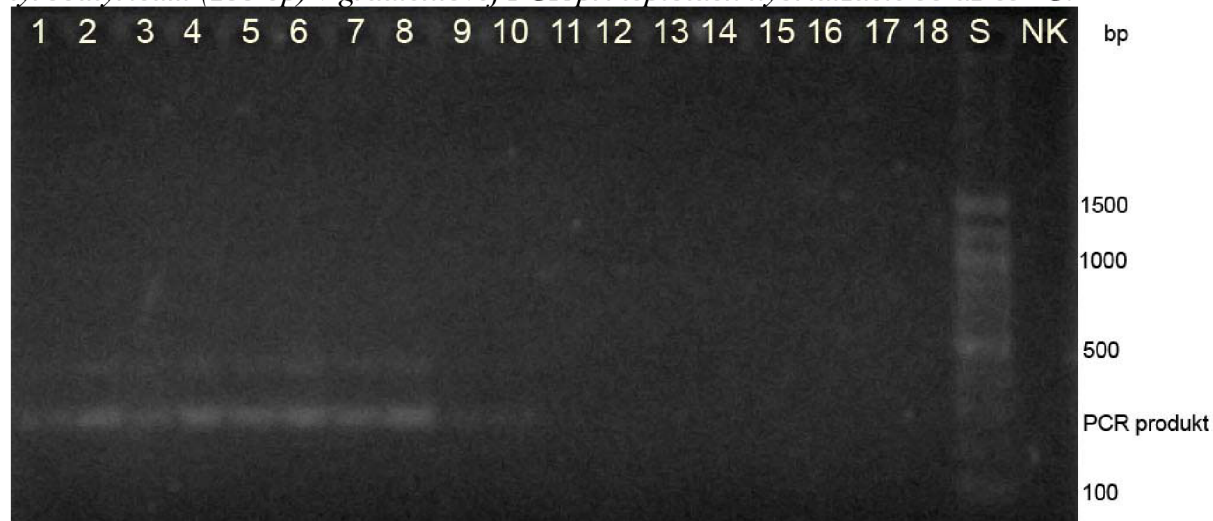
Obr. 26 Agarózová gélová elektroforéza PCR produktov špecifických pre druh C. tyrobutyricum (233 bp) v gradientovej PCR pri teplotách hybridizácie 55 až 65 °C.
