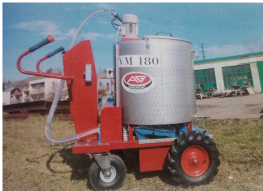
Obrázek 12 – Milktaxi – Vozík pro ohřev, pasterizaci a rozvoz mléka telatům (foto z Návodu k obsluze)
