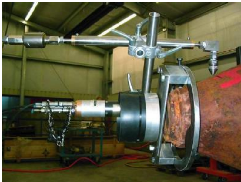
Obrázek 6.6: Řez těla munice dálkově ovládaným manipulátorem v dílenských podmínkách (Šmíd, 2021)
