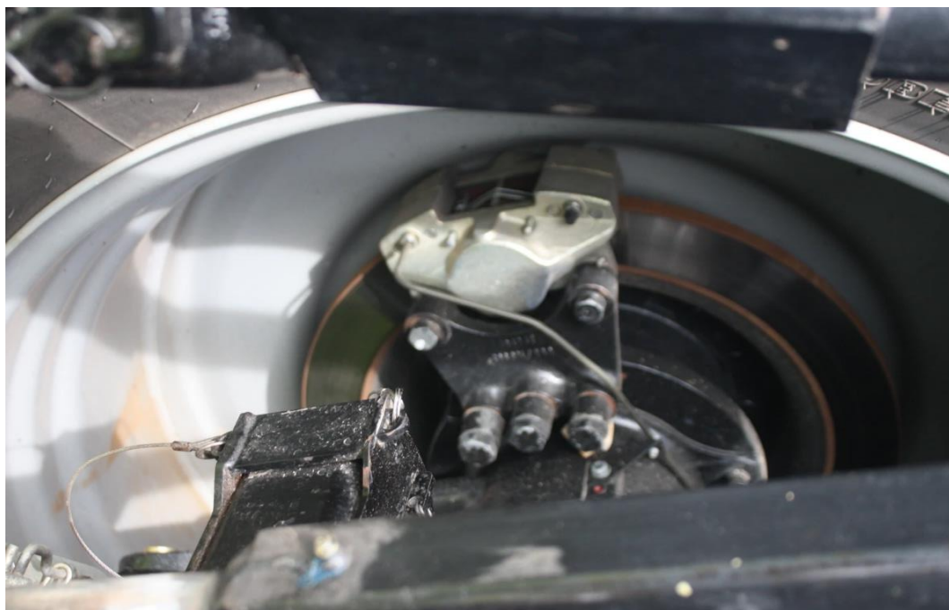
Obrázek 2: Montáž kotoučové brzdy na tažený zemědělský stroj [16]
