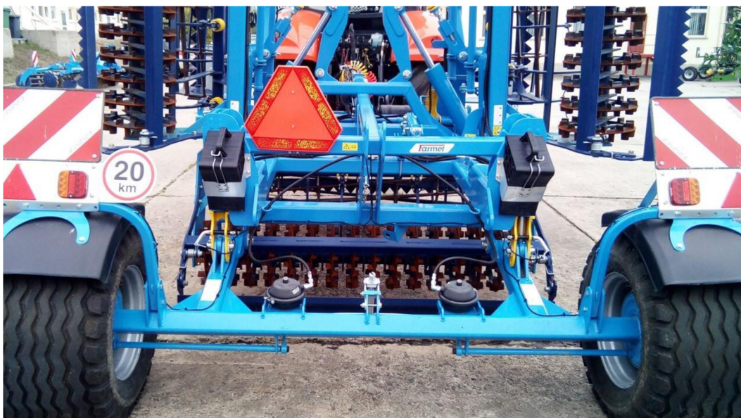
Obrázek 3: Bubnové brzdy na kypřiči Farnet [6]
