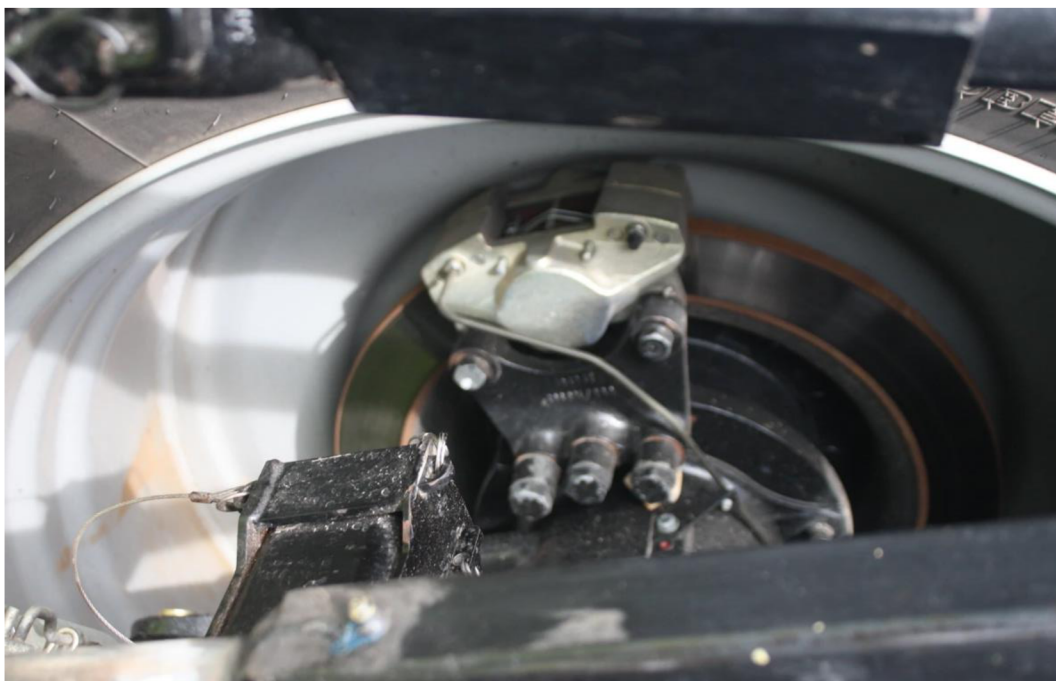
Obrázek 2: Montáž kotoučové brzdy na tažený zemědělský stroj [16]
