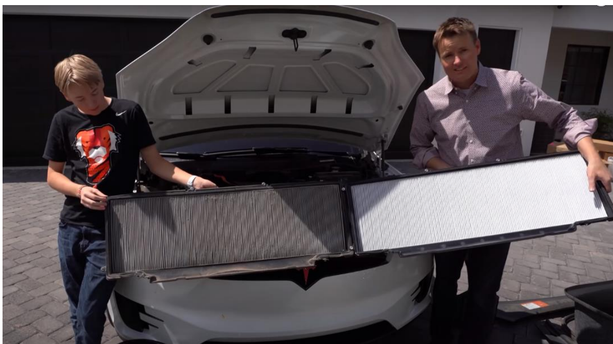
Obrázek 22 – HEPA filtr z Tesly model X po 80 000 km a pro srovnání filtr nový [Převzato z 23]
