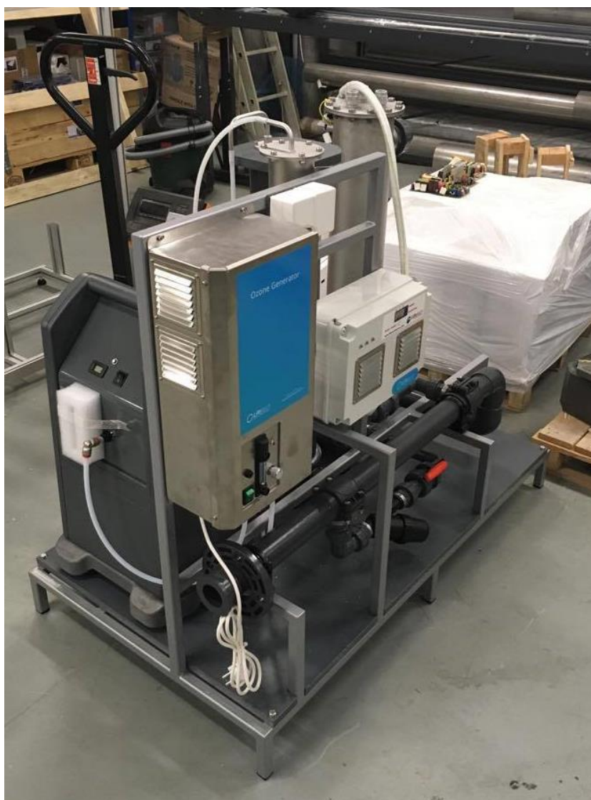
Obrázek 16 – Komplexní zařízení pro úpravu vody pomocí ozonu a UV záření [Vlastní zpracování]
