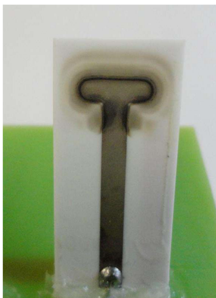
Obrázek 36 – Jiskřiště po 120 h provozu [Vlastní zpracování]
