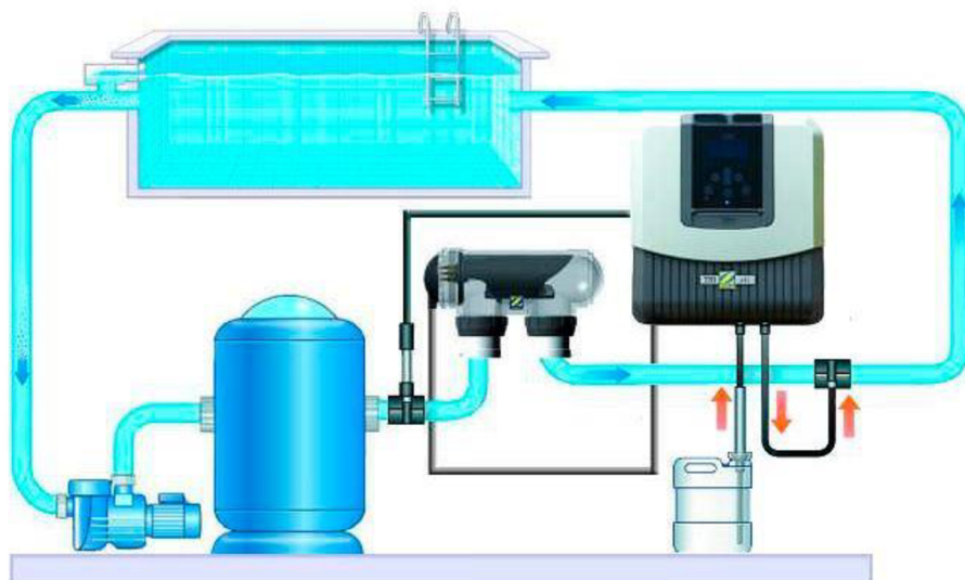
Obrázek 10: Dezinfekce bazénové vody použitím chlóru [44]
