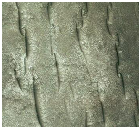
Obrázek 13: Detail vnitřního povrchu polypropylenové trubky (zvětšení 50×) [46]
