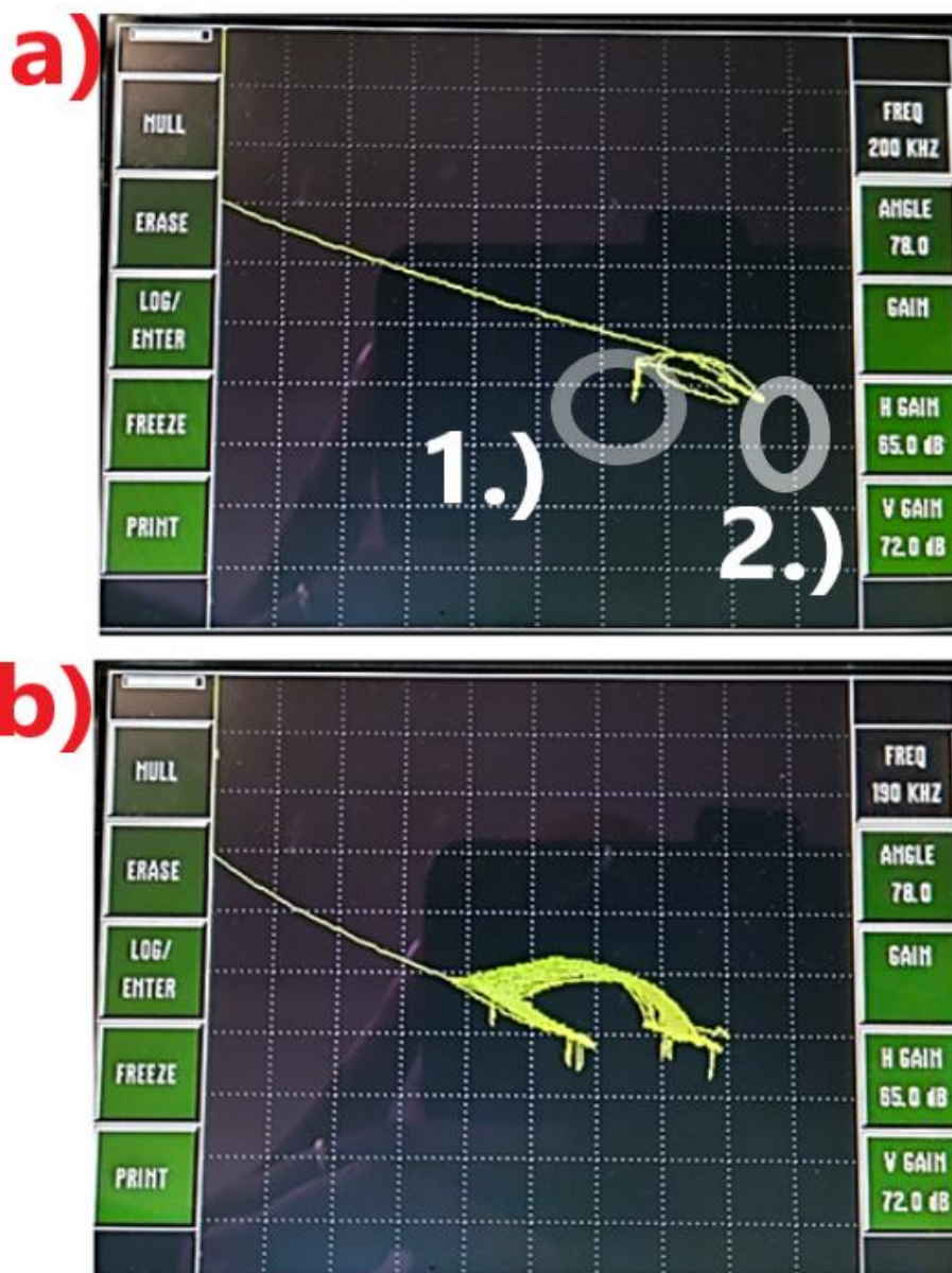
Obrázek 13 - Vyhodnocení tlumících účinků nátěru etalonového listu na indukci vířivých proudů sondy typu MP.060-60BL
