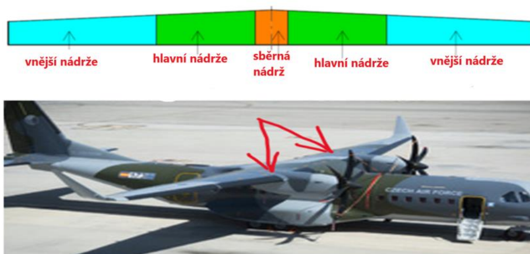
Sedimentace nádrží u letadla CASA C295M
