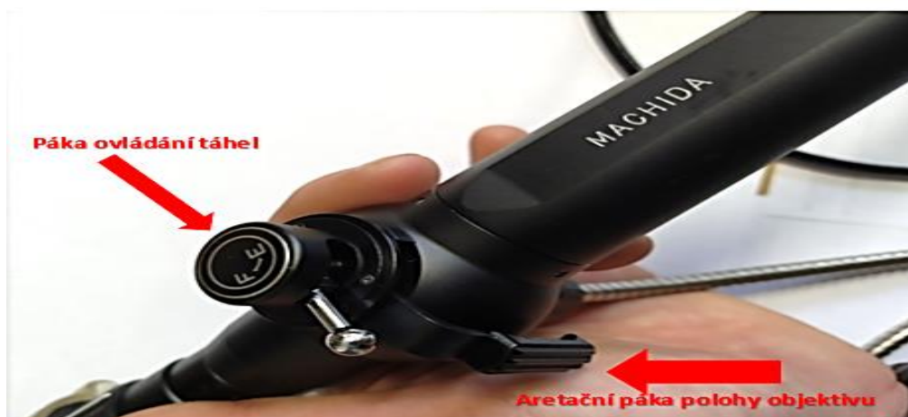
Nepřímá vizuální kontrola – Videoskop Olympus pro universální využití na letecké technice
