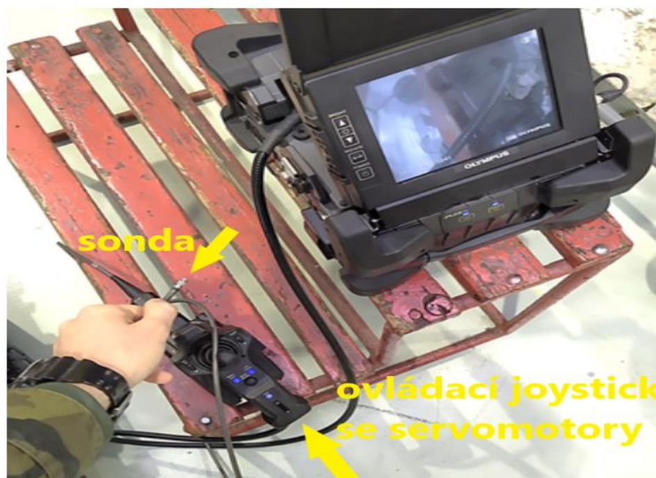
Nepřímá vizuální kontrola – Videoskop Olympus pro universální využití na letecké technice
