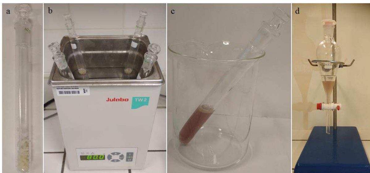
Obrázek 5: a) Zkumavka s navázkou vzorku, b) Zahřívání vzorků ve vodní lázni, c) Změna zbarvení směsi po 10 minutách zahřívání, d) Extrakce tuku organickými rozpouštědly v dělicí nálevce (horní organická fáze)
