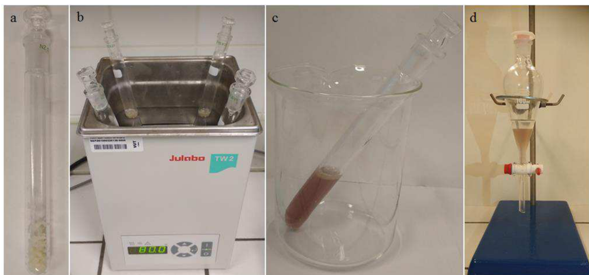
Obrázek 5: a) Zkumavka s navážkou vzorku, b) Zahřívání vzorků ve vodní lázni, c) Změna zbarvení směsi po 10 minutách zahřívání, d) Extrakce tuku organickými rozpouštědly v dělicí nálevce (horní organická fáze)
