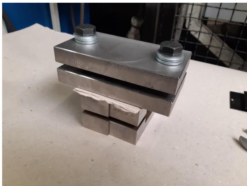
Obrázek 4.15 Stlačení lepeného spoje a jeho vytvrzení.
