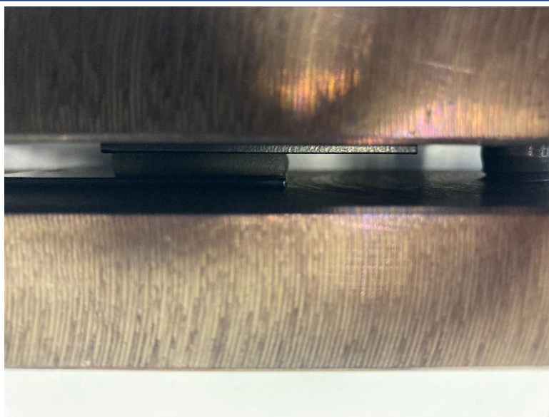
Obrázek 4.16 Míra stlačení lepeného spoje ocelovými deskami.
