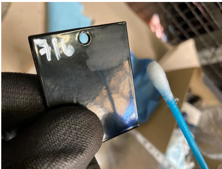
Obrázek 4.18 Zkouška vytvrzení povlaku pomocí MEK.
