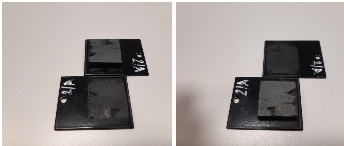
Obrázek 4.34 Vzorek 2/A po tahové zkoušce smykem.
