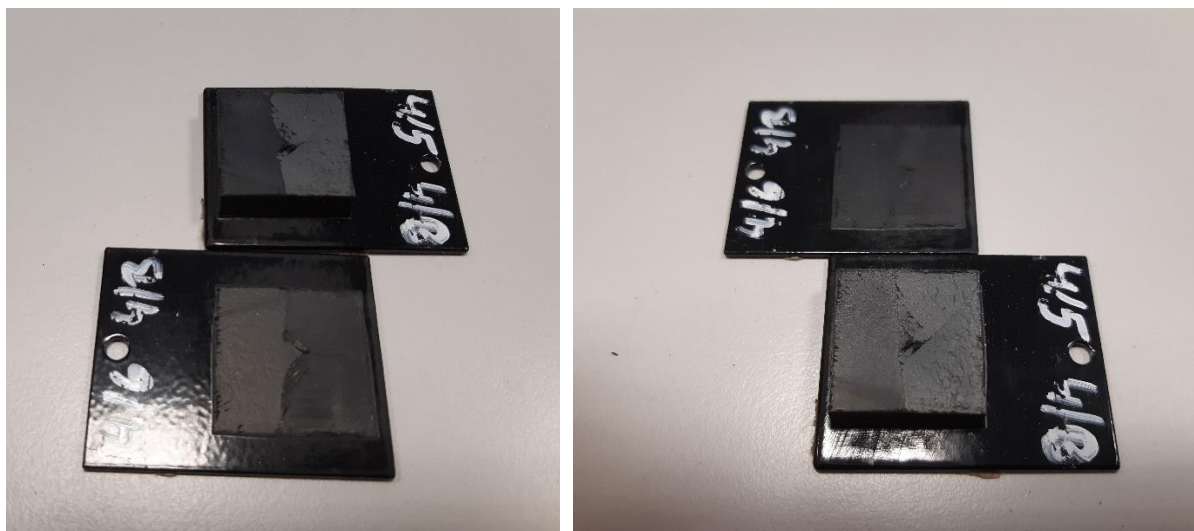
Obrázek 4.38 Vzorek 4/B po tahové zkoušce smykem.
