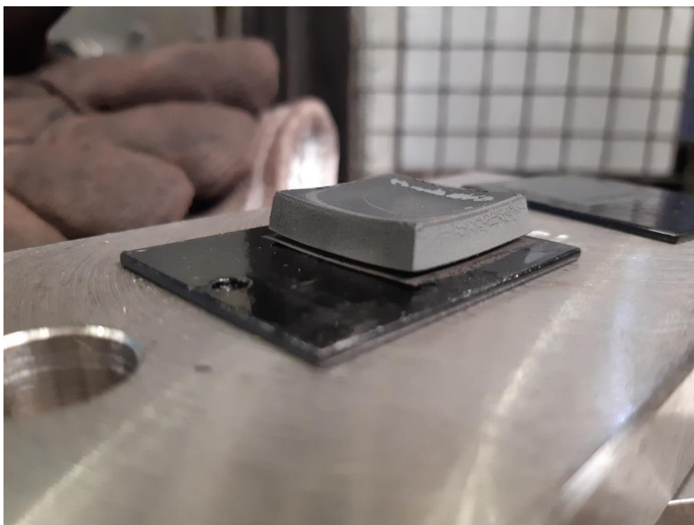
Obrázek 4.17 Vada při lepení nevytvrzených plechů.
