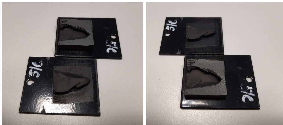
Obrázek 4.40 Vzorek 5/C po tahové zkoušce smykem.
