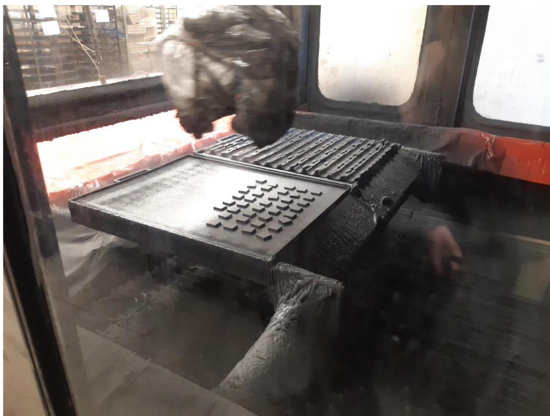
Obrázek 4.14 Nástřik lepidla na pryžové díly.
