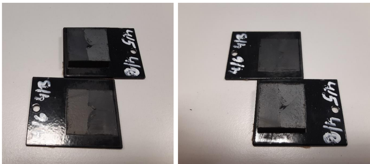
Obrázek 4.38 Vzorek 4/B po tahové zkoušce smykem.
