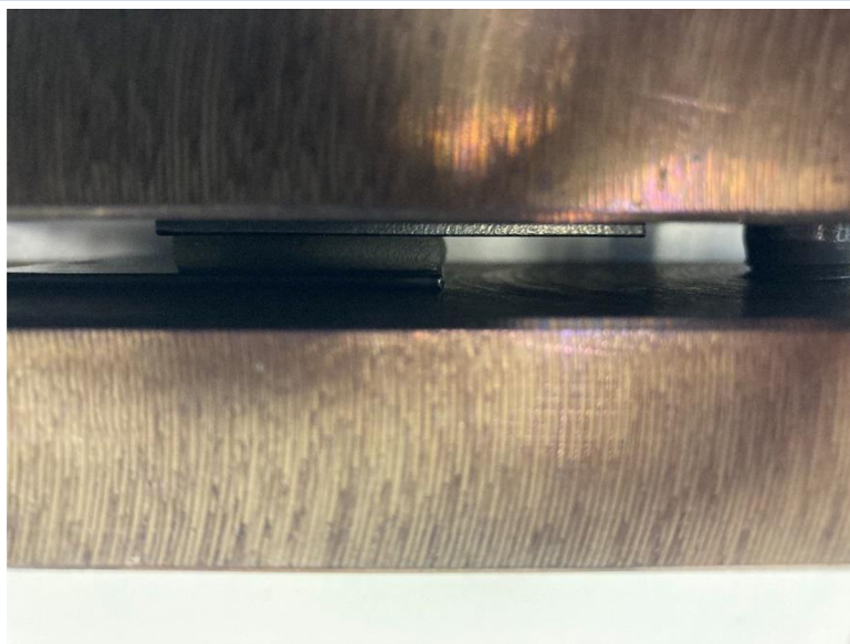
Obrázek 4.16 Míra stlačení lepeného spoje ocelovými deskami.
