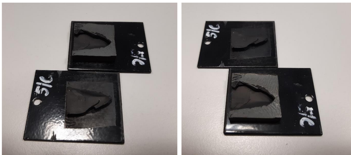
Obrázek 4.40 Vzorek 5/C po tahové zkoušce smykem.
