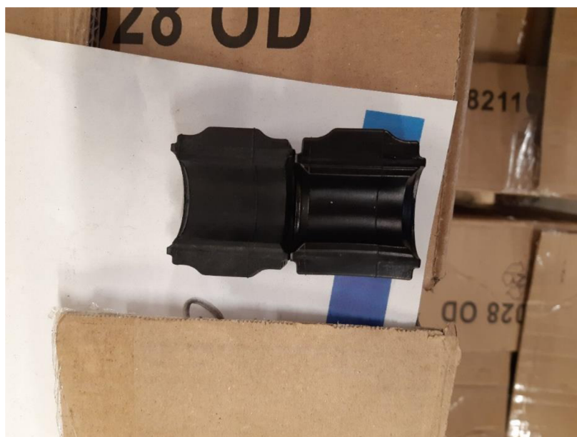
Obrázek 4.11 Pryžová pouzdra: před temperací (vlevo) a po temperaci (vpravo).
