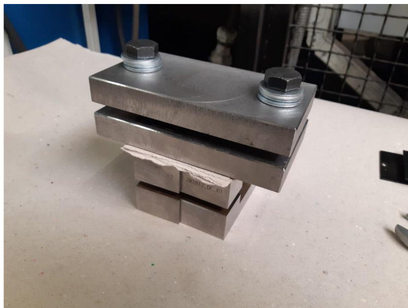
Obrázek 4.15 Stlačení lepeného spoje a jeho vytvrzení.
