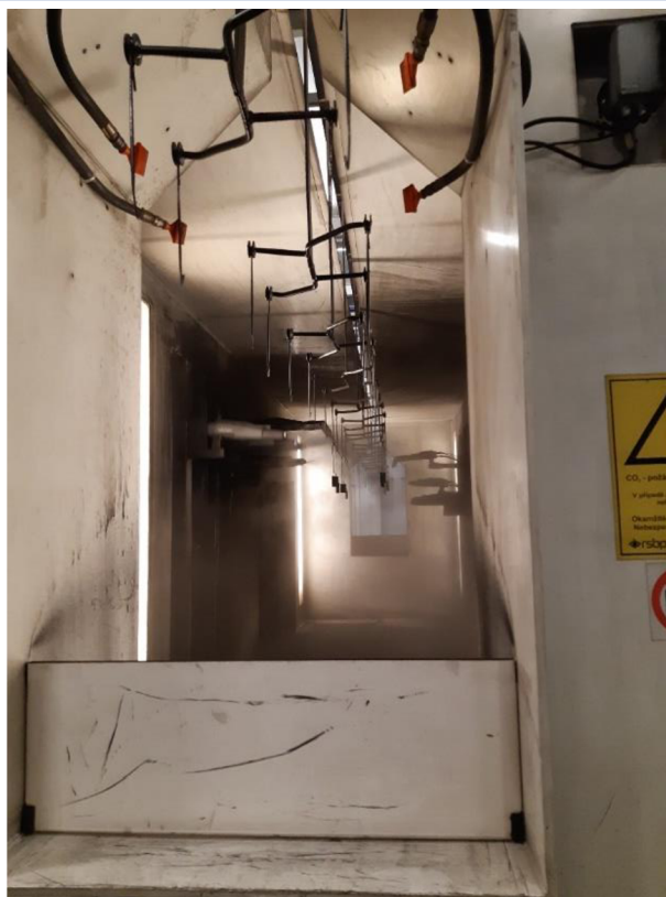
Obrázek 4.6 Nanášení prášku v lakovací kabině.
