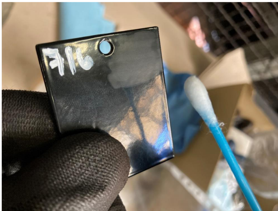
Obrázek 4.18 Zkouška vytvrzení povlaku pomocí MEK.
