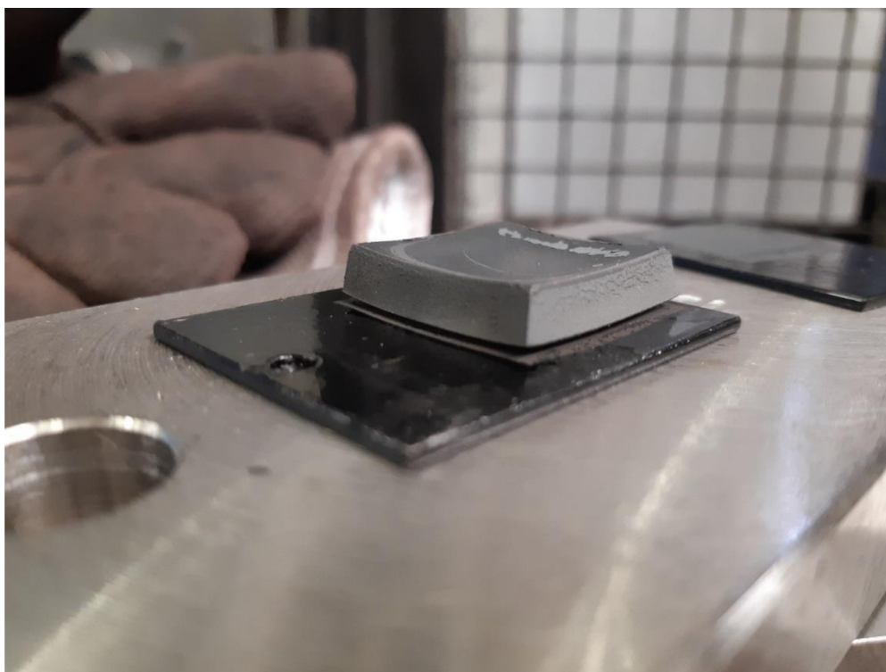
Obrázek 4.17 Vada při lepení nevytvrzených plechů.
