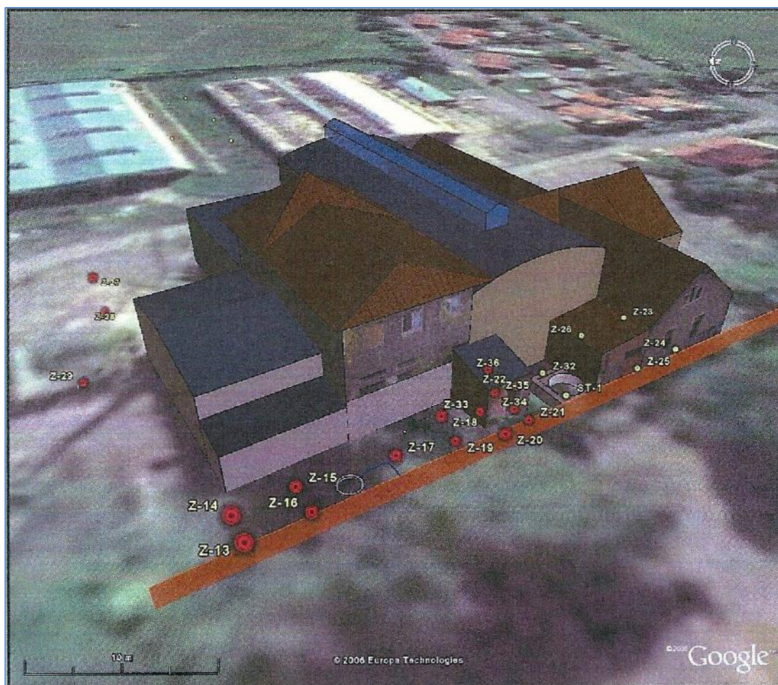
Obrázek č. 10 Polohy sond pro měření Cl-U v půdním vzduchu (Bartošová a kol., 2006)
