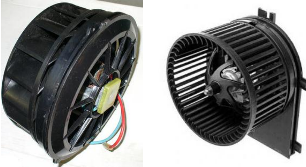
Obr. 18: A) ventilátor topení (Škody 120), B) novodobý ventilátor v automobilech (Škoda Octavia)
