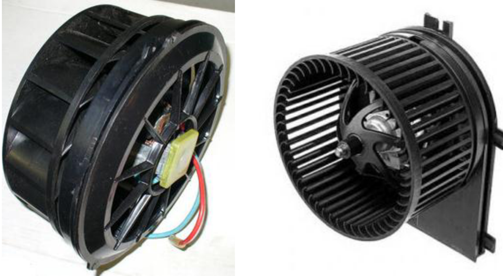
Obr. 18: A) ventilátor topení (Škoda 120), B) novodobý ventilátor v automobilech (Škoda Octavia)
