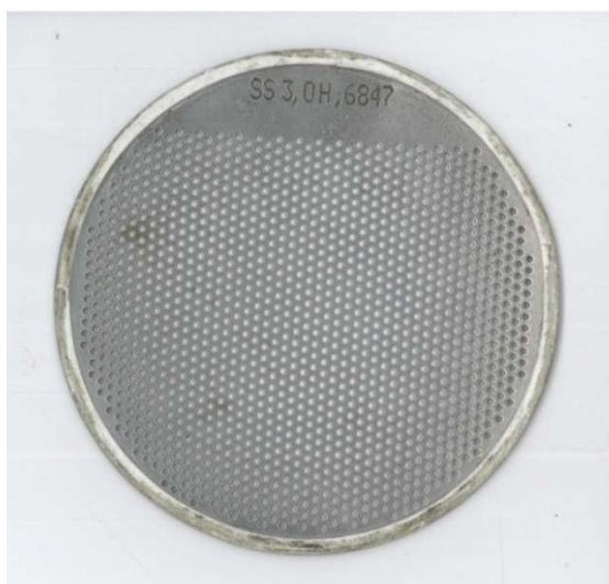
Obr. 1 Kontrolní sítko velikost ss3 H (s průměrem děr 1,42 \pm 0,02 mm).
