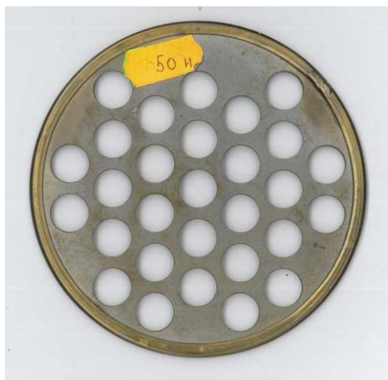
Obr. 2 Kontrolní sítko velikost ss50 H (s průměrem děr 12,32 \pm 0,02 mm).
