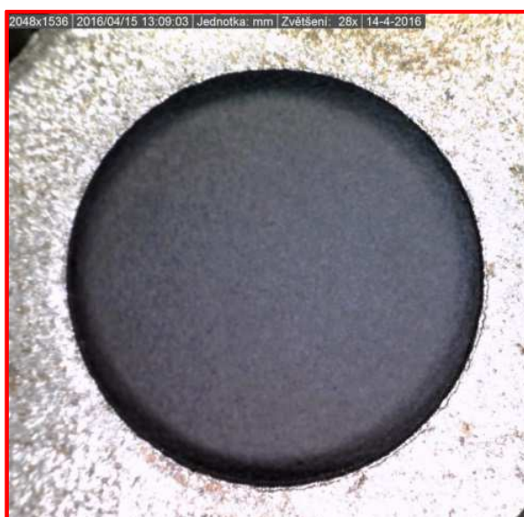
Obr. 5 Kontrolní sítko velikost ss3 H nasnímané z mikroskopu a) nasnímané celé sítko, b) nasnímaný otvor sítko (zvětšení 165,9x).
