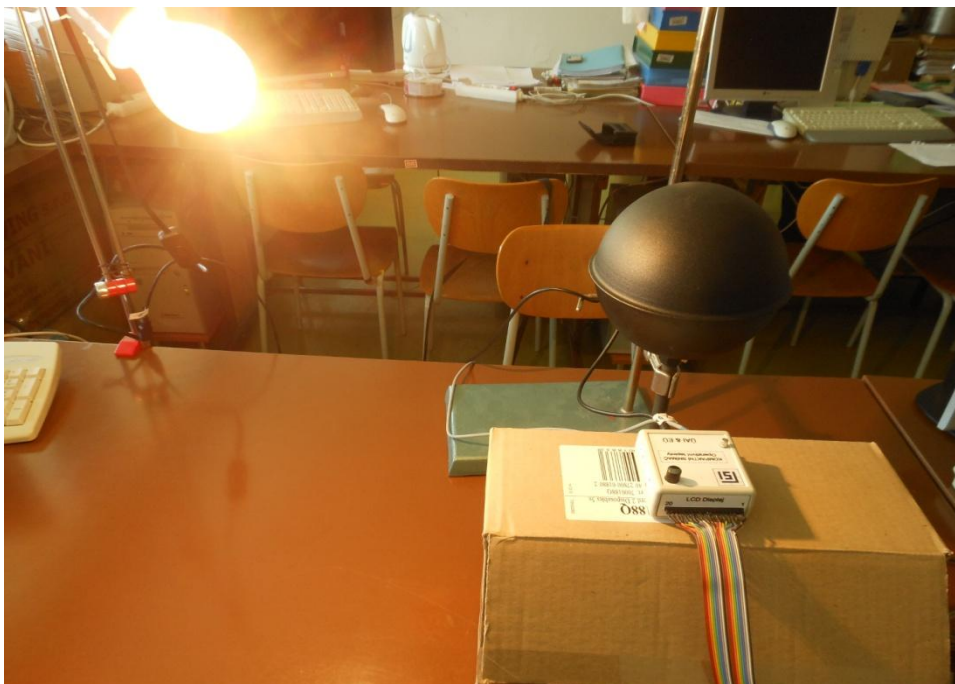
Obrázek 5.5: Snímač operativní teploty a kulový teploměr měří radiační teplotu prostředí s rozsvícenou žárovkou.
