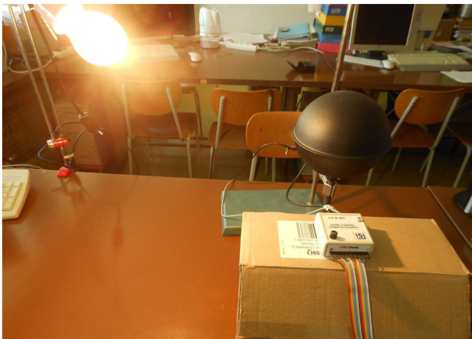
Obrázek 5.5: Snímač operativní teploty a kulový teploměr měří radiální teplotu prostředí s rozsvícenou žárovkou.
