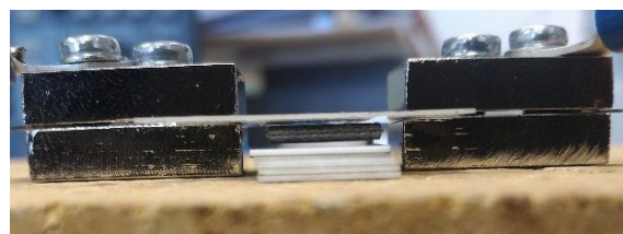
Obrázek 22: AlN šablona připravená na proces osazení a pájení (pohled z boku)
