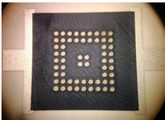
Obrázek 18: Přímou vyhřívaná šablona z 96% Al 2 O 3
