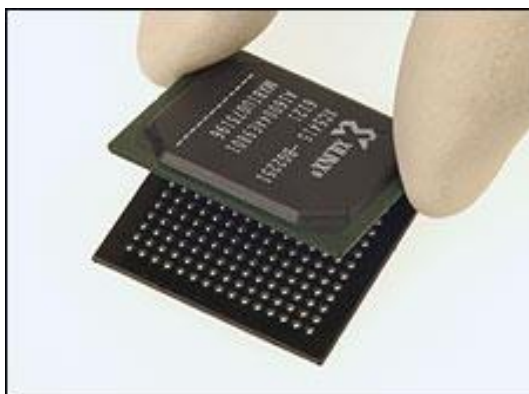
Obrázek 2: Šablona s kulovými pájkovými preformami EZReball [9]
