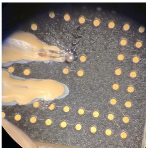
Obrázek 31: Vzorek připravený pro měření teploty na pouzdře BGA a v pájkové kuličce při procesu pájení.
