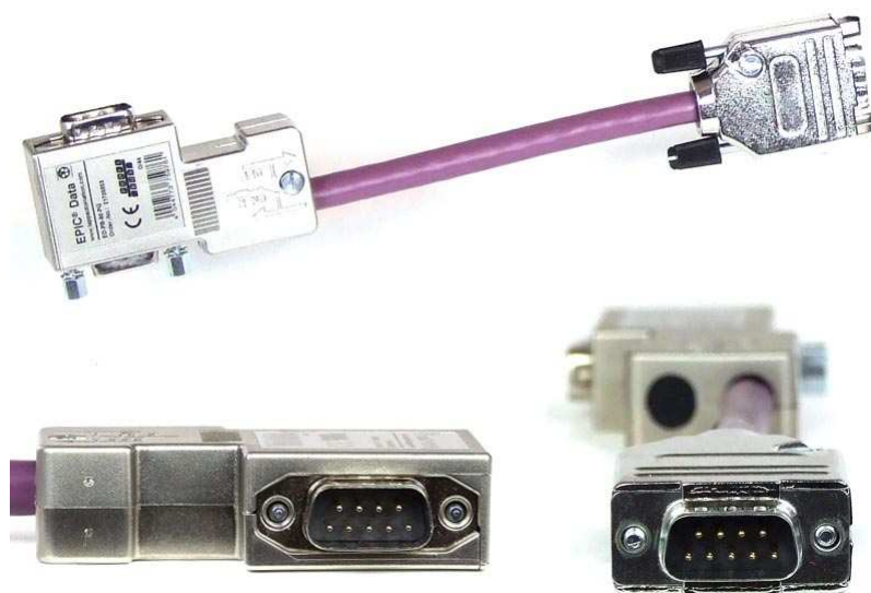
Obrázek 2, 9 pinový D-sub konektor
