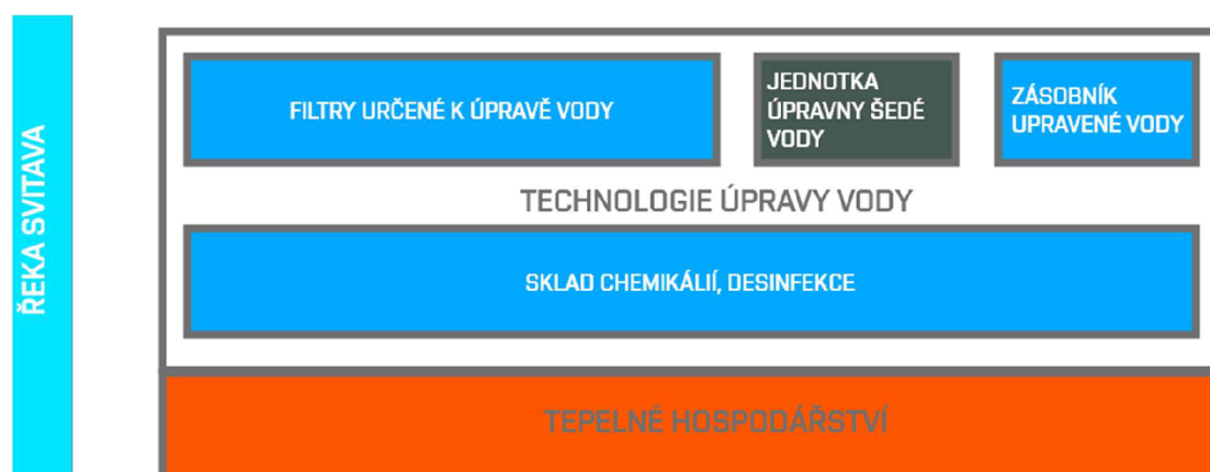
Obr. 7.18 Umístění úpravny šedé vody
