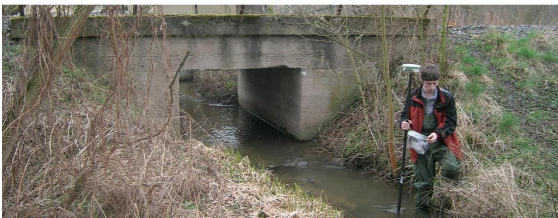
Obr. č. 3: Měření osy vodního toku pomocí aparatury Leica GPS 1200
