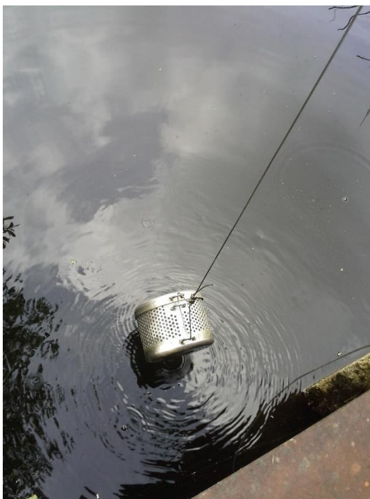
Příloha 3: Instalace ochranné klece s SPMD na lokalitě č. 1 (nádrž v areálu skládky v Lhenicích) (foto M. Let)
