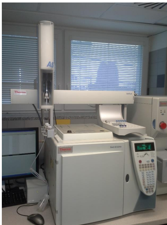
Příloha 13: Plynový chromatograf (GC) TRACE™ Ultra s tandemovým hmotnostním spektrometrem (MS/MS) s trojitým kvadrupólem TSQ Quatum XLS (firma Thermo Fisher Scientific) (foto M. Let)
