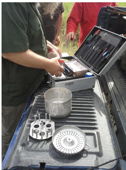
Příloha 1: Příprava ochranné klece a nosiče pro SPMD (foto M. Let)
