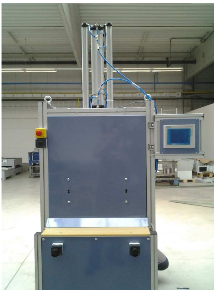
Obr. 2.13 Nahřívací transformátor NT7.
