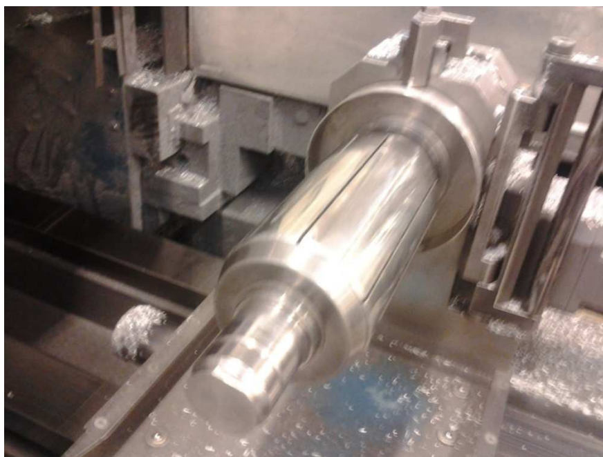
Obr. 1.3 Upínací trn jednoúčelového stroje Taylor.
