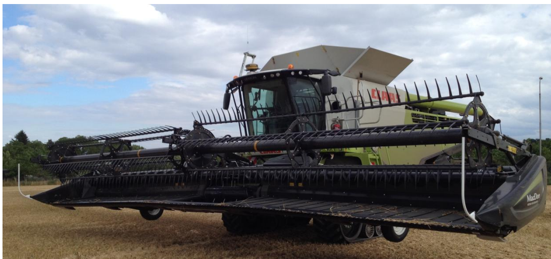
Obrázek 13 – Žací adaptér MacDon FD 75 o záběru 12,2 metru
