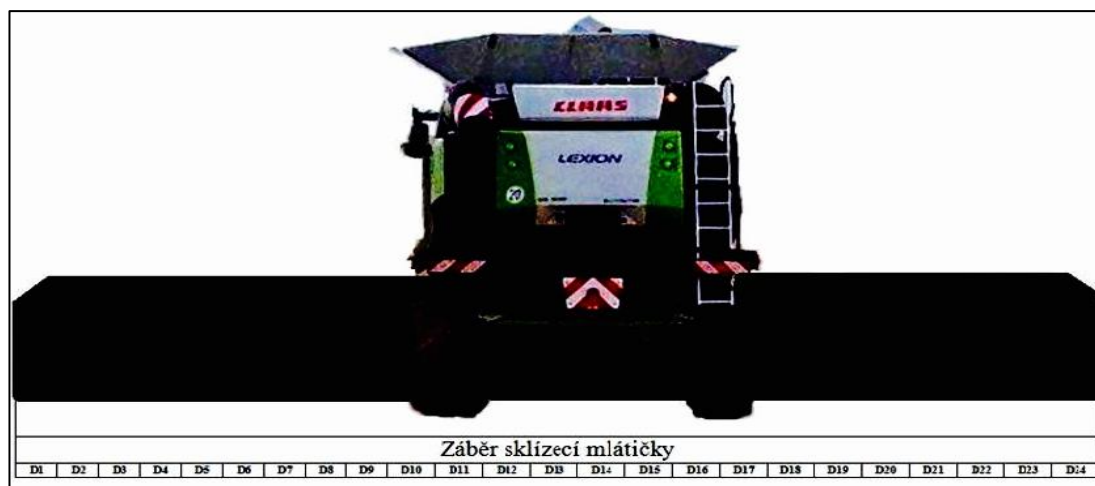
Obrázek 16 – Záběr sklízecí mlátičky rozdělen na 24 oddílů
