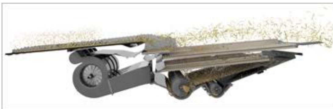
Obrázek 8 – Systém čištění JET STREAM
