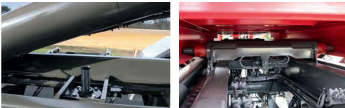
Obr. 30 Pomocný hydraulický valec pre výsypný cyklus a vnútorný hydraulický zamykací mechanizmus kontajnerového rámu [38]
