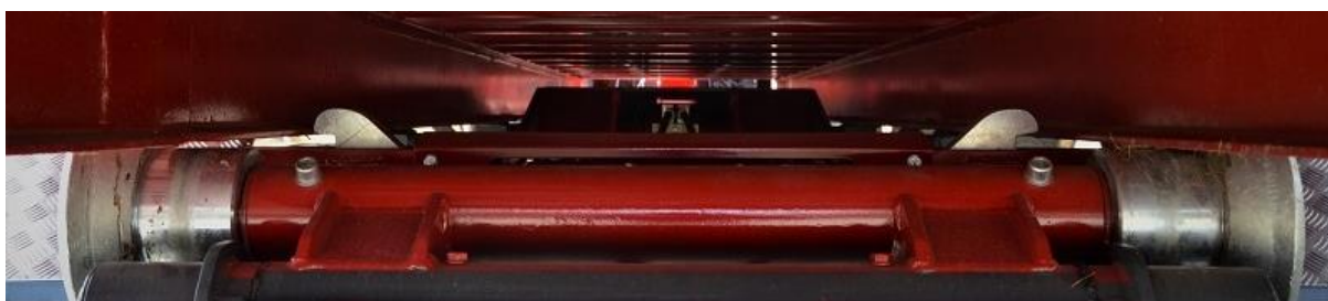
Obr. 35 Detail na zamykací mechanizmus Portýr 16
