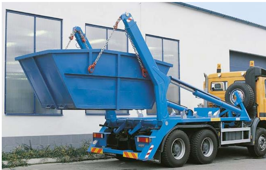
Obr. 7: Vykladací/nakladací cyklus ramenového nosiča [8]
