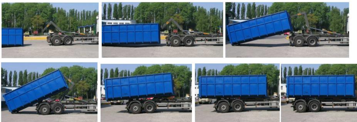
Obr. 12: Základná schéma natáhovacieho procesu [15]
