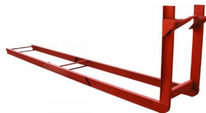
Obr. 2: Základný rám typu Abroll - rozmery dané normou [4]
