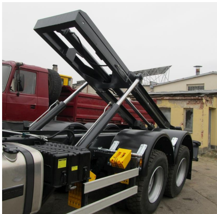
Obr. 25: Nový strmeňový hákový nosič na podvozku Tatra Phoenix od spoločnosti Silscrap Tábor [28]
