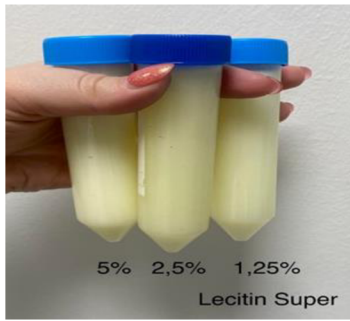
Obr. 63 LS v cukerném roztoku → emulzifikace pomocí tyčového mixéru
