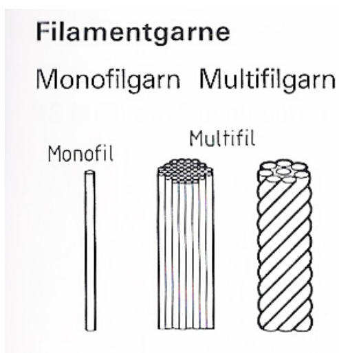
Obrázek 1: Zleva do prava - monofil, nezpevněný multifil a zákrutem zpevněný multifil [3]
