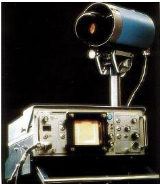
Obrázek 3: Jedna z lékařsky široce používaných kamer AGA Thermovision
