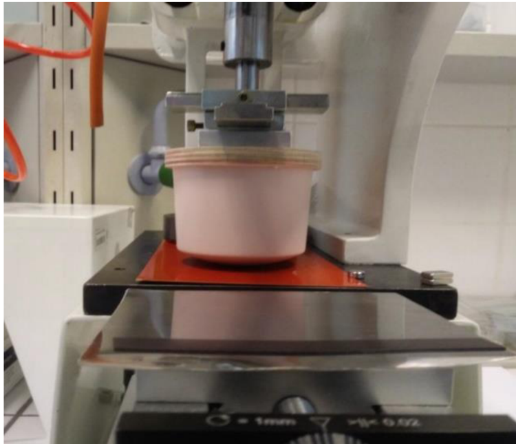
Obr. 22: Tampónový ručný tlač. stroj s využitím silikónového tampónu okrúhleho tvaru [30]
