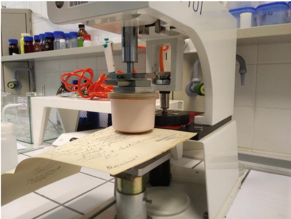
Obr. 24: Potláčanie archívnych dokumentov tampónovým ručným tlačovým strojom
