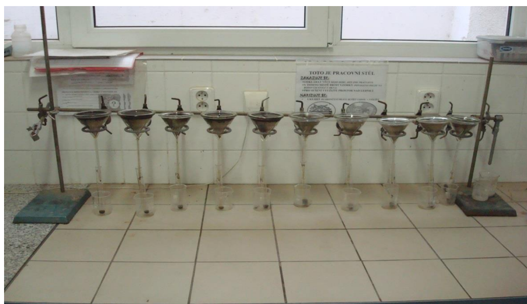
Obrázek 8 Technické řešení úpravy fugátu laboratorní filtrací
