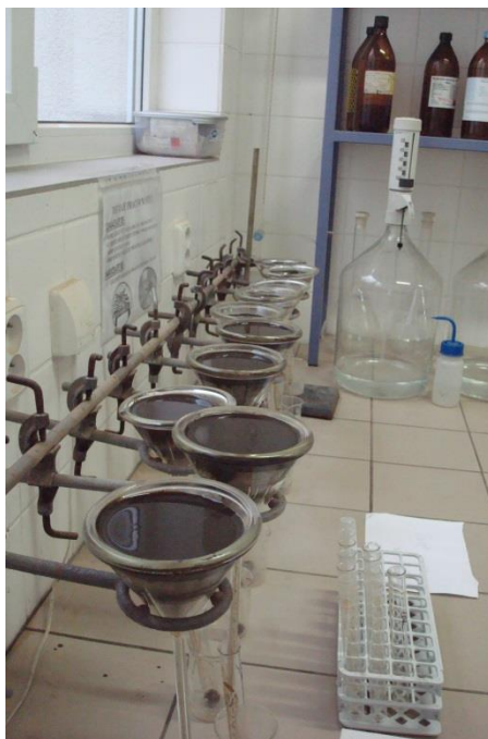
Obrázek 9 Detailní řešení úpravy fugátu laboratorní filtrací
