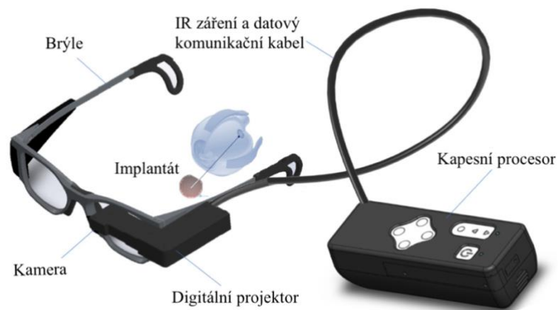
Obr. 12: Konstrukce systému Prima. (upraveno) [55]
