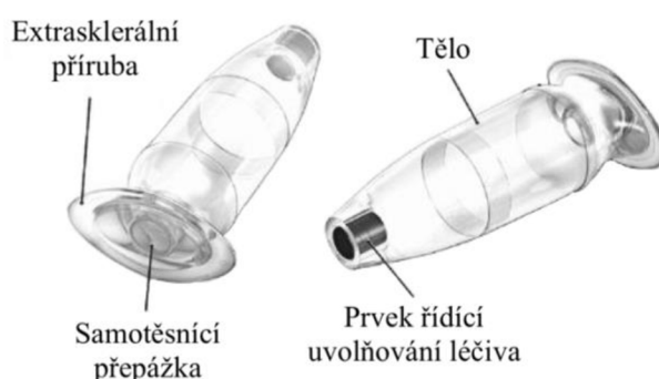
Obr. 5: Konstrukce implantátu Susvimo. (upraveno) [24]
