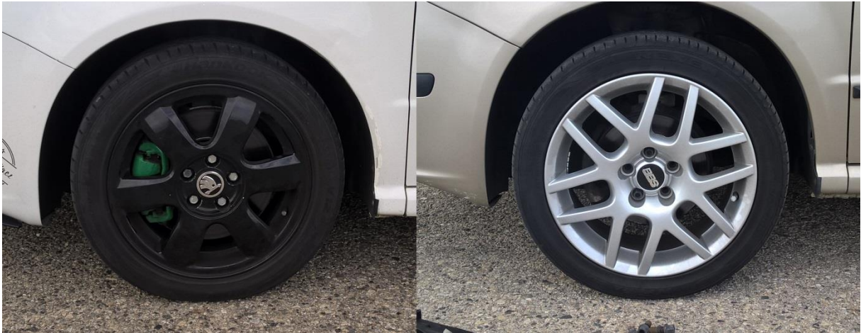
Obr.č. 46 - Porovnání rozměrů předních brzd a použitých kol [Vlastní zdroj]
