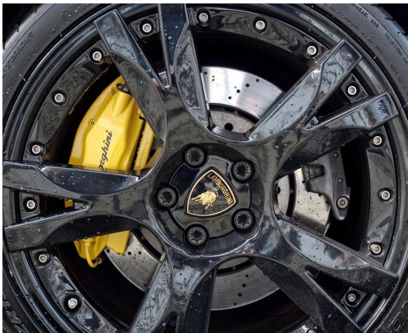
Obr. č. 13 - Zadní brzdy Lamborghini Galardo se samostatným brzdovým třmenem parkovací brzdy [30]
