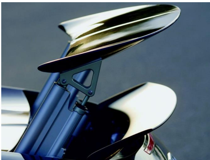
Obr. č. 5 - Výsuvná aerodynamická brzda vozu Bugatti Veyron 16.4 [7]
