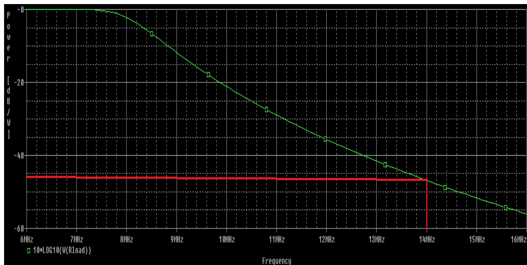
Obr. 3.11: Přenosová charakteristika filtru 7 MHz s vyznačenou druhou harmonickou
