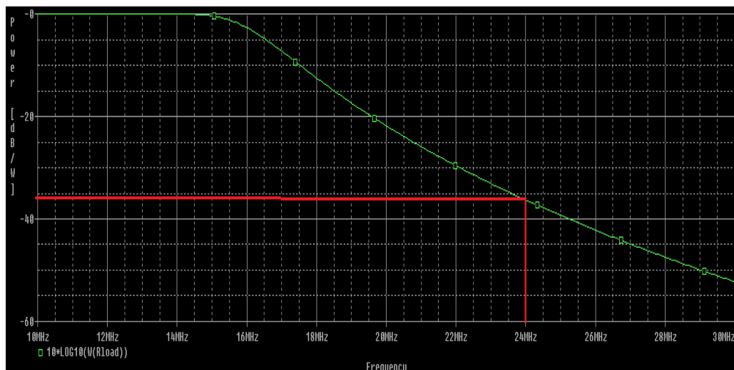
Obr. 3.13: Přenosová charakteristika filtru 14 MHz s vyznačenou druhou harmonickou
