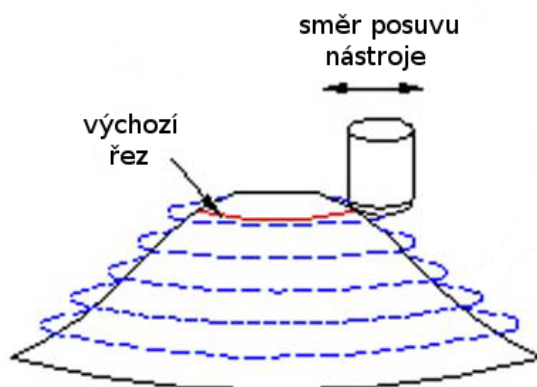
Obrázek 13: Princip výpočtu dráhy horizontální strategie. Zdroj [3].
